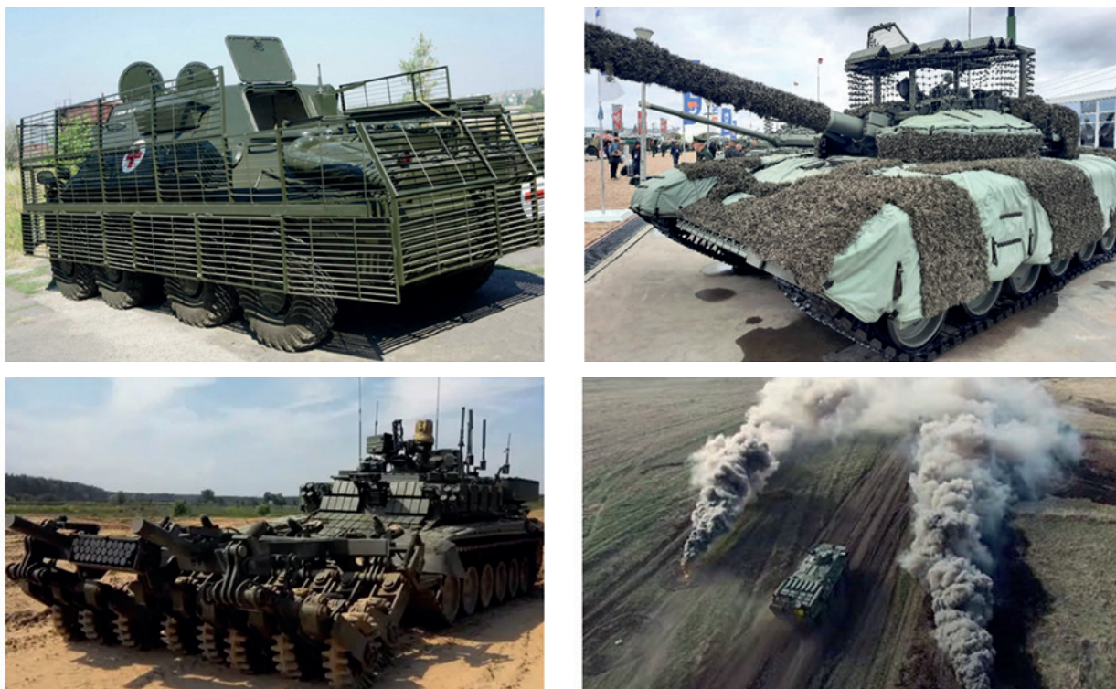
Рис. 4. Средства и способы противодействия средствам поражения бронетехники
