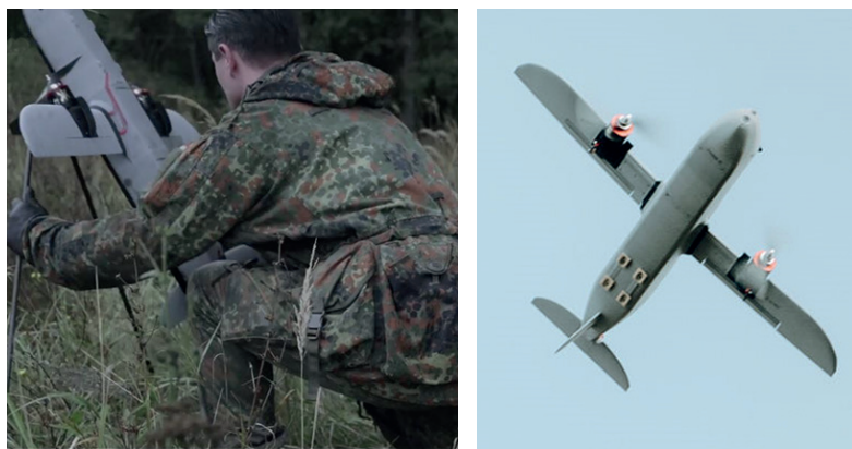
Рис. 8. БПЛА-перехватчик Tytan. Масса 5 кг, а полезная нагрузка — 1 кг. Скорость до 300 км/ч, дальность до 20 км. Высокая степень автономности (обнаружение, захват цели, наведение). Способен осуществлять перехват воздушных целей на встречных курсах. Основная задача — перехват ударных ДПЛА типа «Герань-2» и схожих с ними малоскоростных воздушных целей
