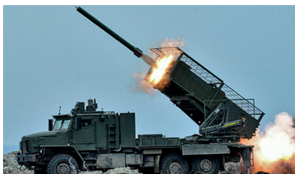
Рис. 6. 220-мм термобарическая реактивная система залпового огня (РСЗО) ТОС-2
