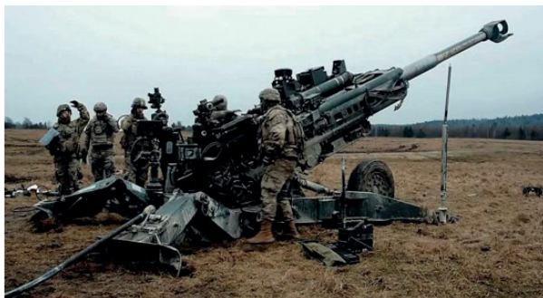
155-мм гаубица М777 (США), дальность стрельбы ОФС до 30 км, снарядом «Excalibur» более 40 км
