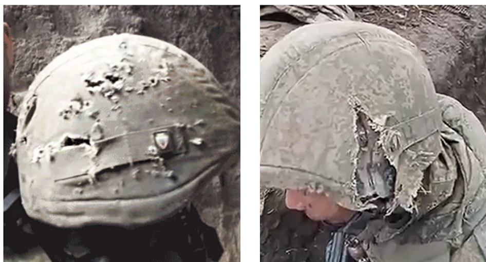
Рис. 3. Металлоорганические бронешлемы «Колпак-20» производства АО «НПО Спецматериалов», спасшие жизнь военнослужащим в зоне проведения СВО
